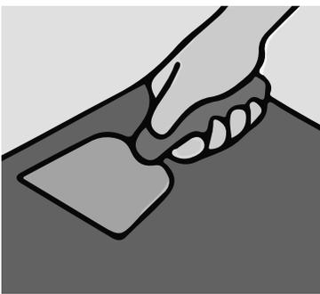
a. Aplicar el adhesivo: Elige el pegamento adecuado para el tipo de alfombra y el tráfico esperado en el área. Aplica el pegamento uniformemente en el suelo utilizando una espátula o rodillo.
