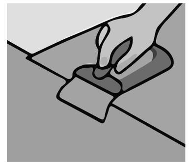
c. Asegurar la adhesión: Usa un rodillo de mano o una pisadera para presionar la alfombra firmemente contra el suelo y asegurar una buena adhesión al adhesivo.
